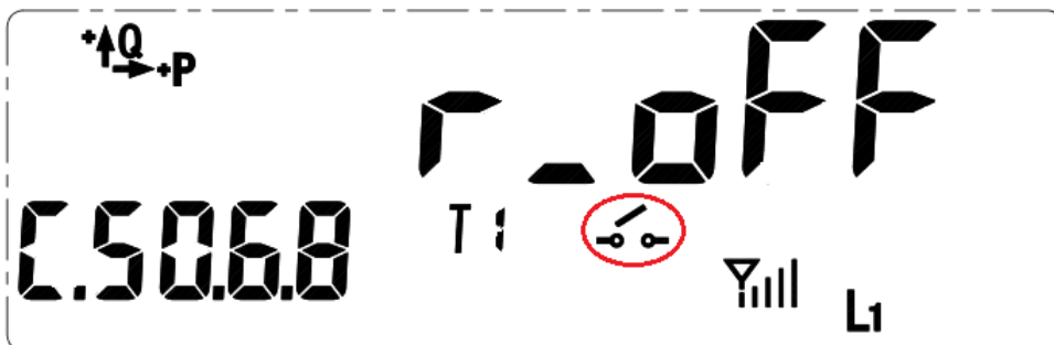
2. ábra Kikapcsolt áramot jelző ábra
